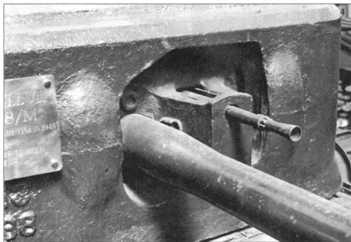
Установка 75-мм пушки в башне
