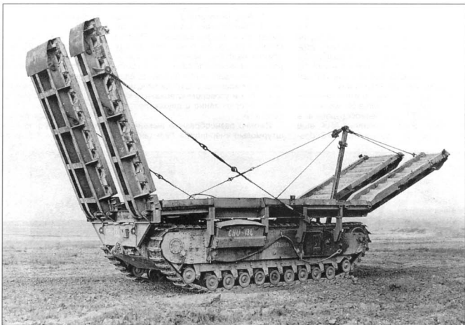
Мосто- укладчик «Черчилль» ARK
