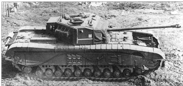
«Черный принц», вид сверху. В отличие от «Черчилля», у А43 коробка воздухозаборников были перенесены с бортов на крышу МТО
