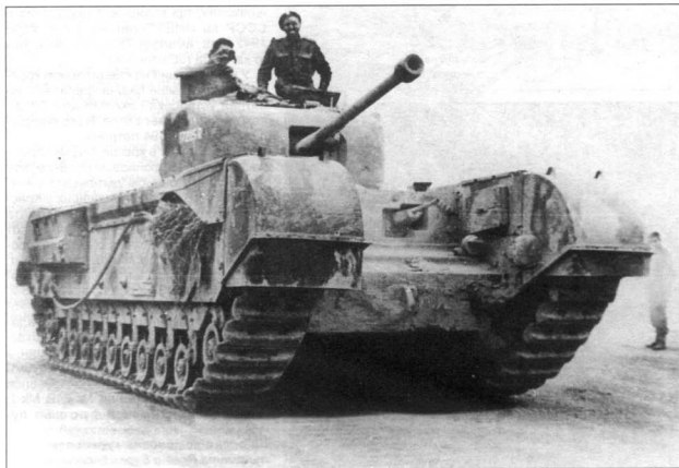
Модификация «Черчилль IV» отличалась от предыдущей главным образом наличием литой башни. На «четверках» чаще устанавливали и длинноствольную 6-фунтовую пушку Mk V
