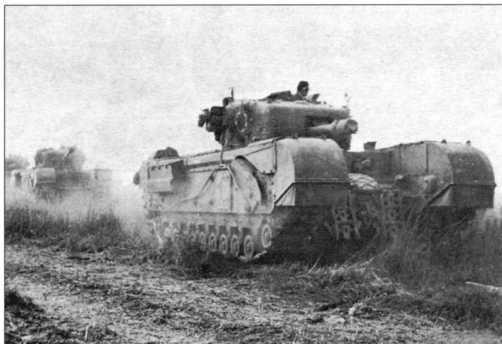
Танк оазисной поддержки «Черчилль V», вооруженный 95-мм гаубицей. Нормандия, июнь 1944 года
